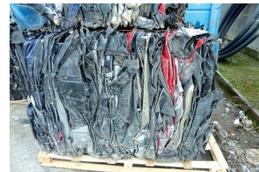
Bloque prensado de parachoques de PP
