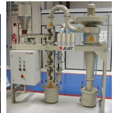
Separador de aire tipo zig-zag (GAIKER)
